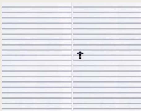
Dobbelt fløjport fyldt med stålplade T-10, fyldretning vandret
